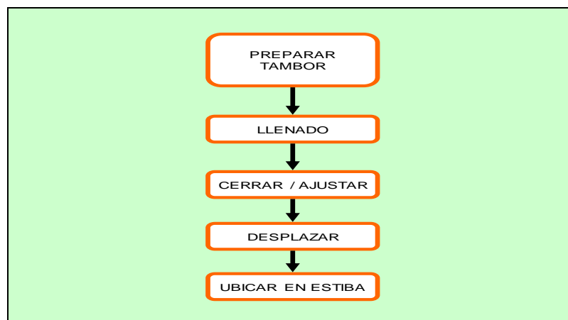
GRAFICA 47. DIAGRAMA DEL PROCESO DE EMPAQUE DE JARABE
