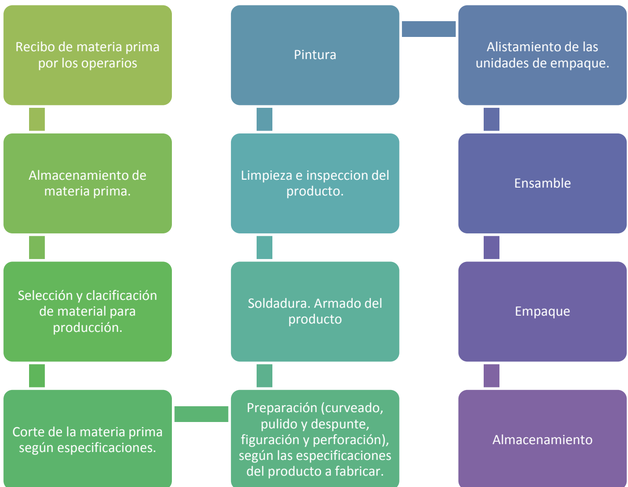
Gráfico 3: Procedimiento de producción línea metálica Impal
