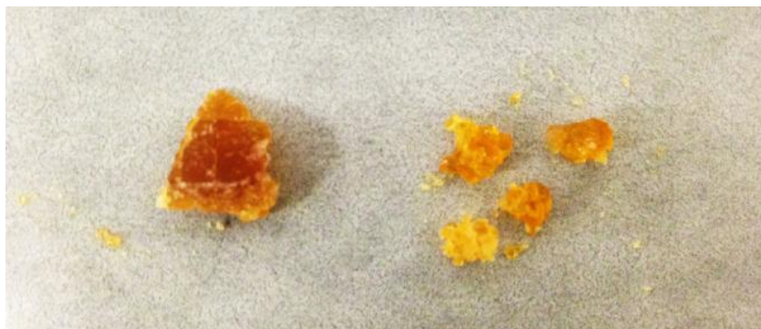
Imagen 2. Comparación del material obtenido del curado del EAC con AM antes (izquierda) y después (derecha) de ser calentado a ebullición en tolueno.
