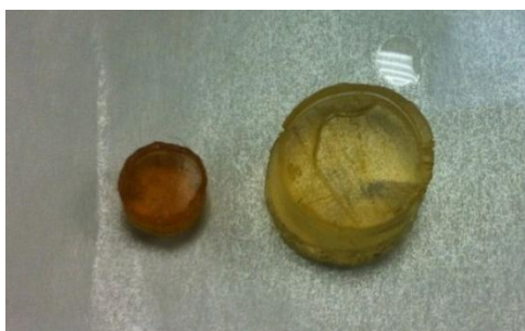
Imagen 3. Estado xerogel (izquierda) y estado hinchado en tolueno (derecha) del material obtenido del curado del EAC con 100% del ACH.
