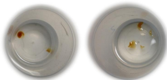
Imagen 4. Fractura de los materiales obtenidos del curado del EAC con AM en el proceso de hinchamiento en Tolueno (derecha) y cloroformo (izquierda).
