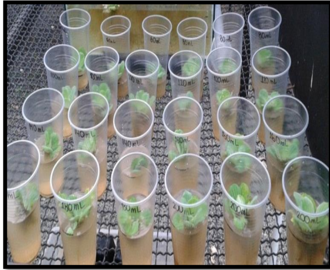
Figura 6. Montaje experimental para determinar el volumen mínimo de agua donde se da un crecimiento óptimo de Pistia stratiotes .
