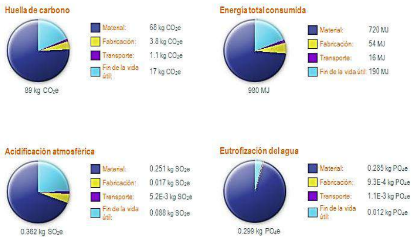
Fig 59. Resultado tubo en acero inoxidable, versión inicial. Molina D. (2015).
