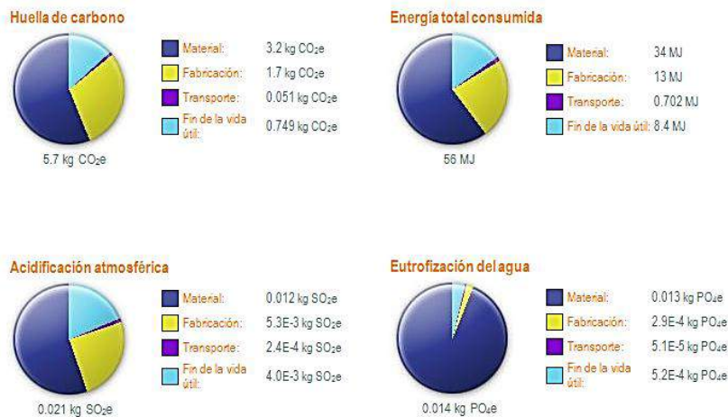
Fig 63. Resultado disco en acero inoxidable, versión inicial. Molina D. (2015).
