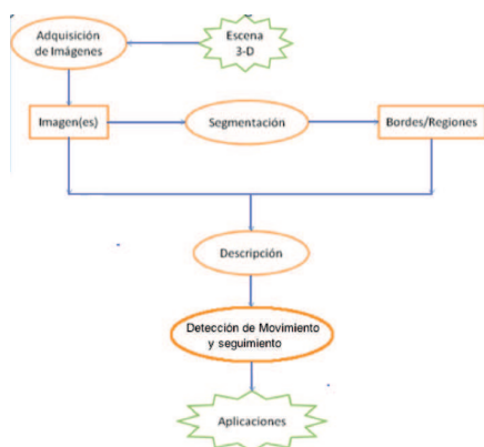
Figura 1. Esquema del sistema de visión Artificial
