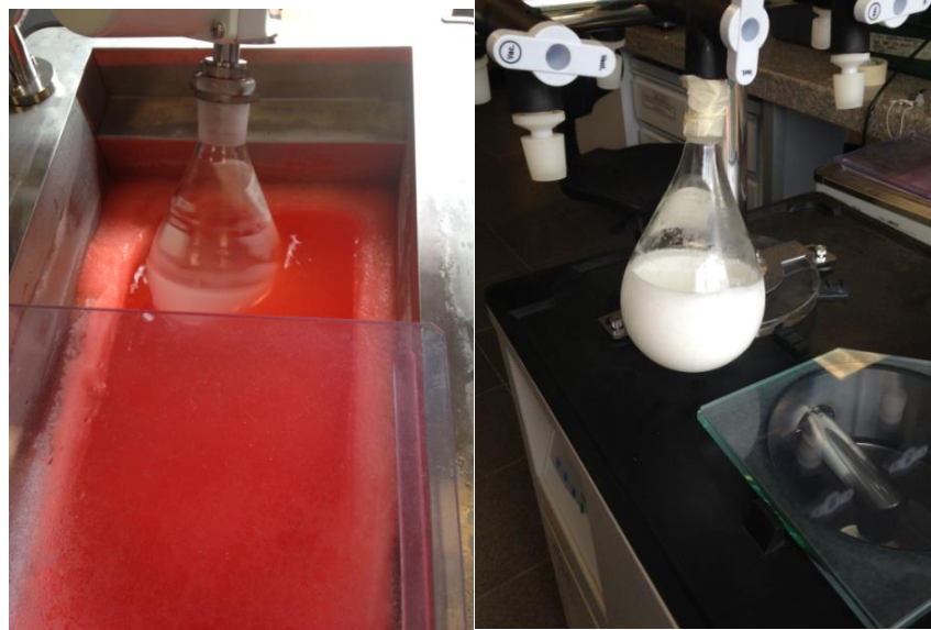
Figura 6. Proceso de liofilización del material polimérico PAM-4Na en un equipo marca EYELA FDU-1110
