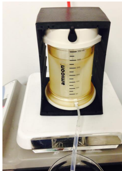
Figura 5. Proceso de ultrafiltración del material polimérico PAM-4Na en una celda marca Amicon®
