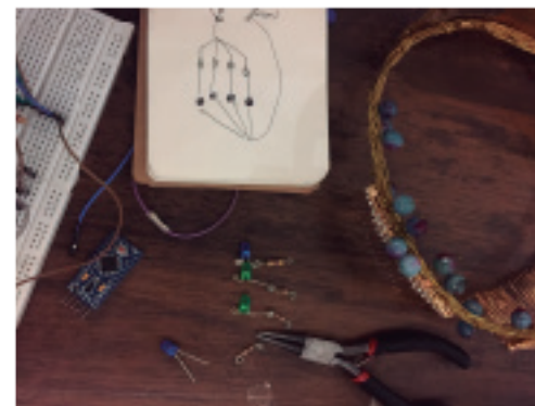
Imagen 21. Esquema conexión arduino-sensor-led
