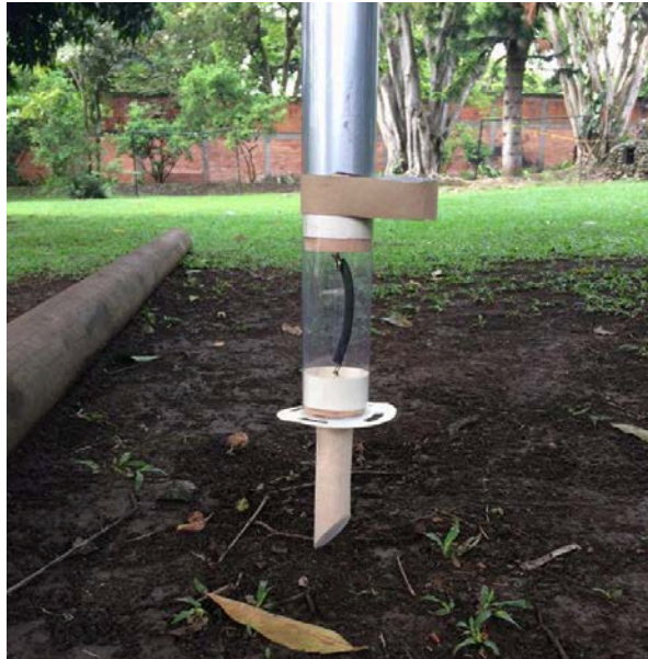
Ilustración 13: Punta para abrir agujeros y mecanismo de pedal para expulsar el abono: Bocache.
