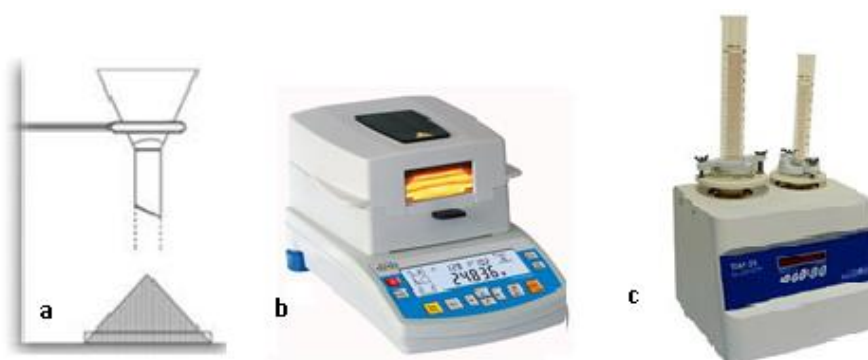
Figura 5. (a) montaje para el método del embudo fijo, (b) Termobalanza (Max 50/1/WH), y (c) Apisonador (Tap-2S).
