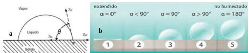
Figura 3. Fuerzas que actúan en una gota de líquido formando un ángulo de contacto \theta (a) (Genaro, 2005); y relación entre el ángulo de contacto y el fenómeno de humectación (b) (TEGO, s.f.).
