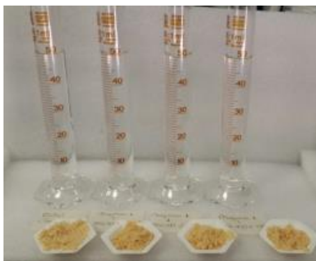
Figura 6. Montaje para la medición del tiempo de humectación.
