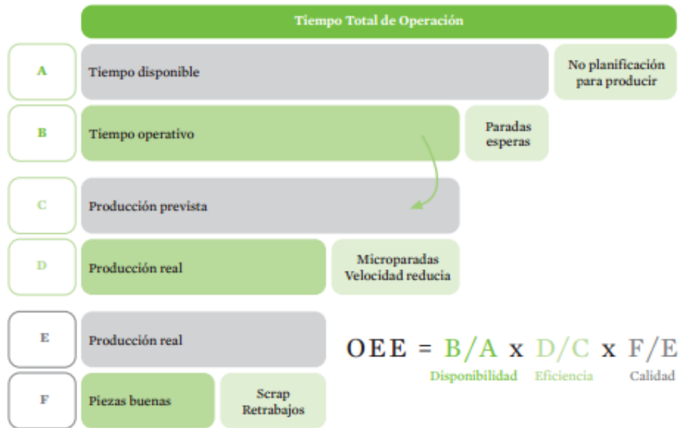
Figura 6 Esquema de los componentes del OEE
