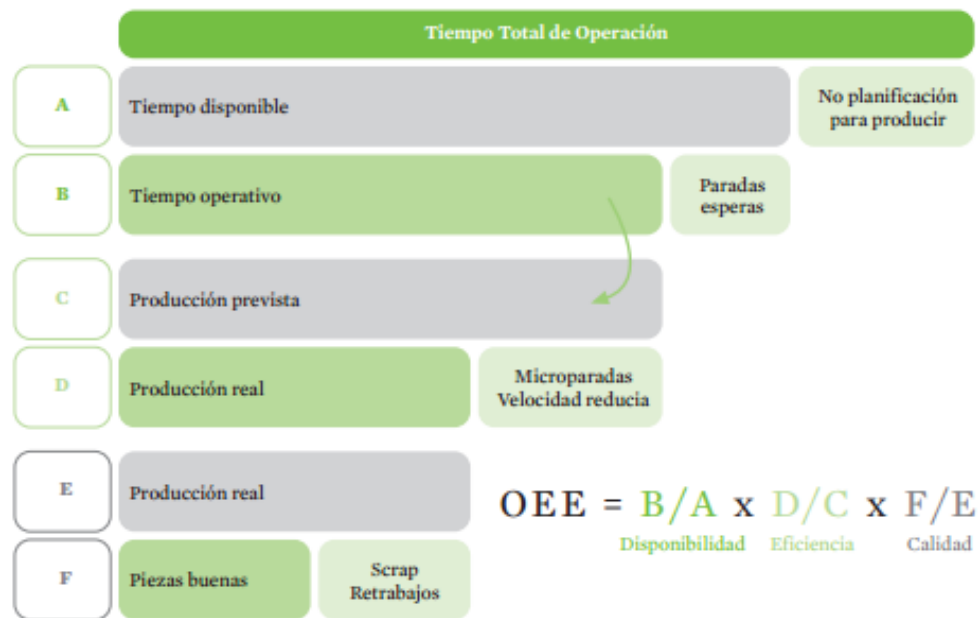
Gráfico 10 Esquema de los componentes del OEE. Fuente: Lean Manufacturing: Conceptos, técnicas e implantación, Escuela de Organización Industrial EOI de España
