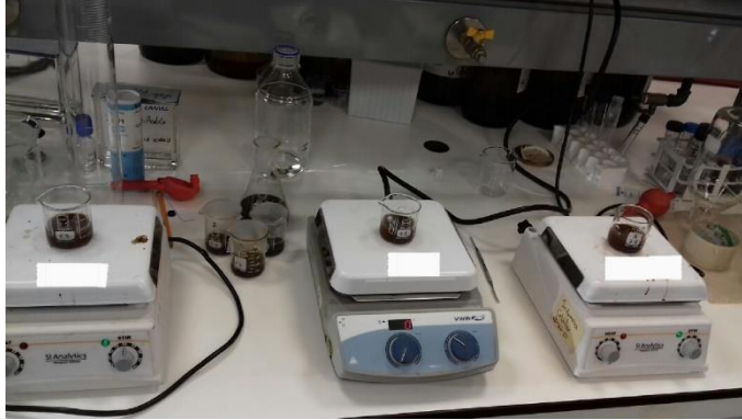
Figura 11. Montaje para el diseño experimental realizado para determinar la relación másica (vinaza: acetato de etilo) óptima.
