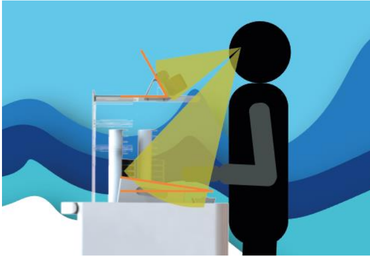
Figura 49 Factores humanos del puesto de trabajo Himo. Inclinationes del contenedor de nutrientes y la herramienta para el montaje.
