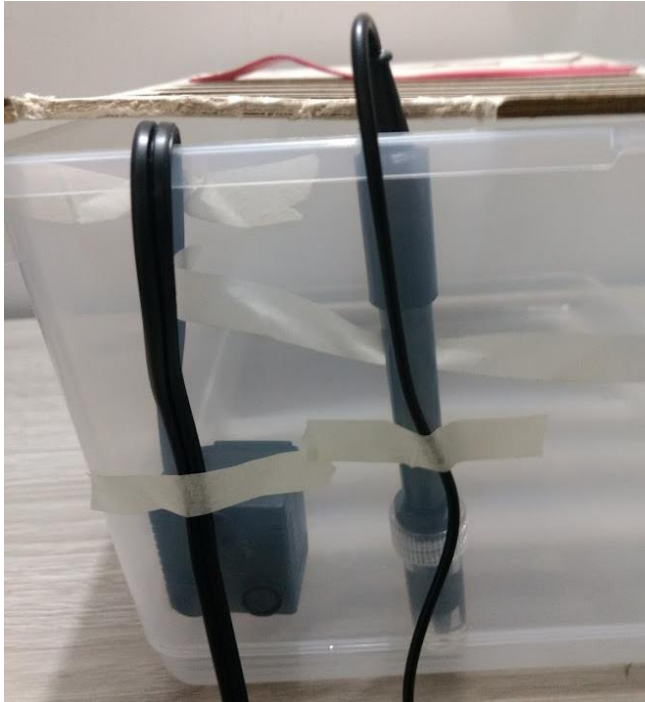
Figura 26 Tanque con agua y una bomba sumergible de recirculación de agua a la izquierda y un pH metro a la derecha.
