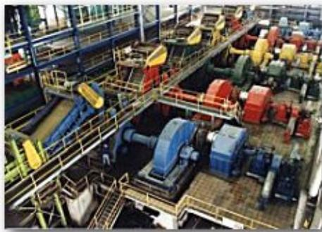
En la Fábrica, tiene lugar como fase inicial, el [muestreo](#), [pesaje y lavado de la caña](#). De ahí, el material pasa a las [picadoras](#) y los [molinos](#). El bagazo resultante en la molienda se emplea en las calderas para la producción del vapor que será la base para generar la [energía](#) necesaria para la realización del proceso. El
