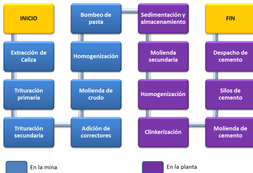
Figura 1. Diagrama del proceso de fabricación de Cemento
