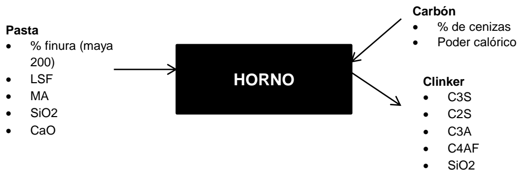
Figura 9. Variables que influyen en la resistencia, dentro de la clinkerización
