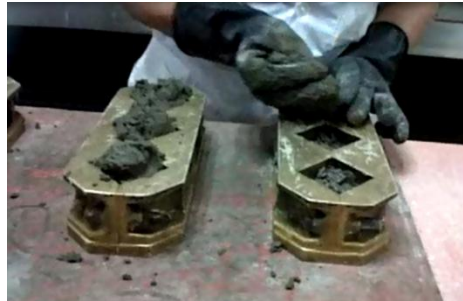
Imagen 11. Segunda capa de mortero en el molde
