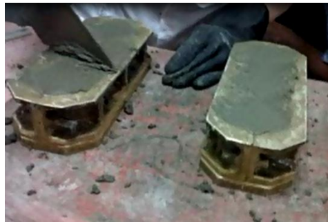
Imagen 12. Retirar el exceso de mortero de la superficie
