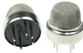
Figura 18. Sensor de control de calidad del aire. Tomada de thaieasyelec.net .
