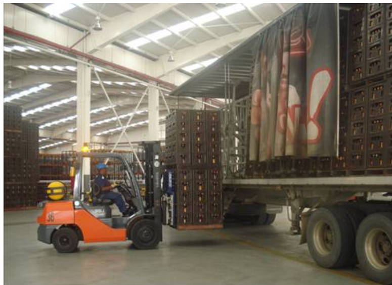
Figura 12 Operación de cargue con montacargas de los Siders Cervecería del Valle.
