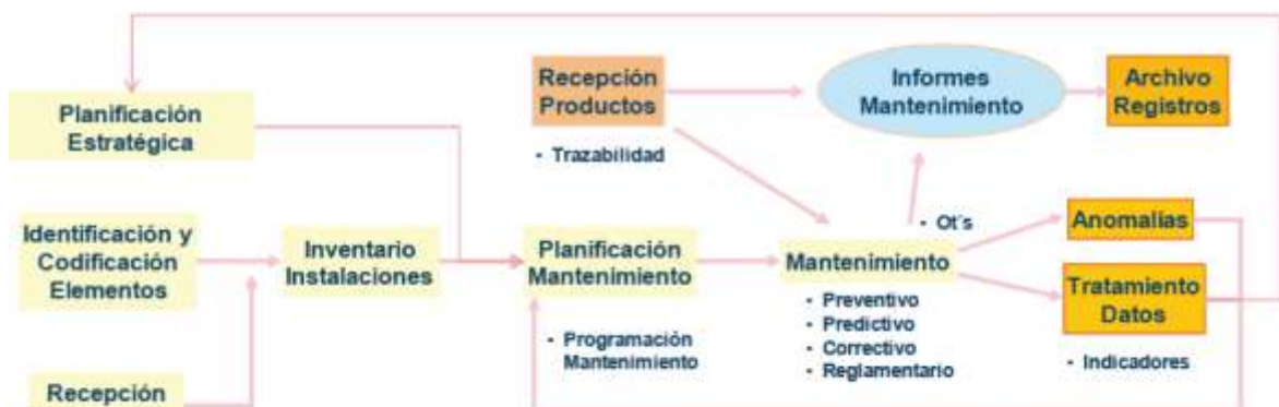
Figura 3. Proceso de gestión del mantenimiento
