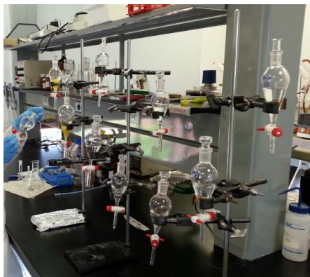
Figura 4. Montaje para el tratamiento de las muestras mediante extracción líquido-líquido.
