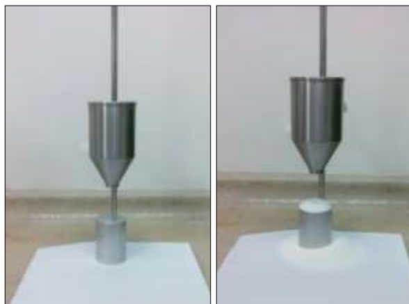
Figura 9. Montaje para la determinación del flujo (Ángulo de reposo).
