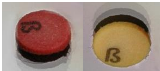
Figura 6: Prueba Cromogénica. Disco amarillo indica no producción de enzimas betalactamasas. Cambio de color del disco a rojo, indica positivo para la producción de enzimas betalactamasas. Imagen tomada de: https://catalog.hardydiagnostics.com/cp_prod/content/hugo/NitrocefDisks
