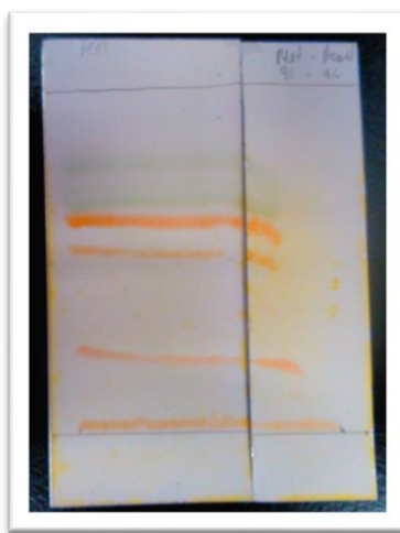
Figura 10. Cromatografía planar del extracto de hojas IA-025. Sistema de revelado: Dragendorff. Fase móvil: Metanol: Acetato de etilo (90:10).
