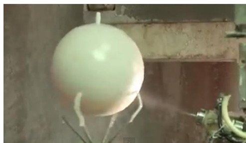
Sistema automático de aplicación de pegamento al neumático
