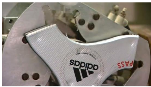
Sistema automático para aplicación de pegamento a las piezas de cuero
