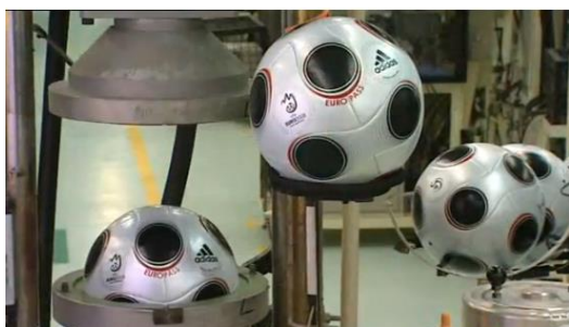
Proceso de vulcanización de balones
