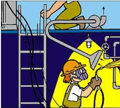
Figura 12 Extracción Localizada de Vapores en Espacios Confinados
