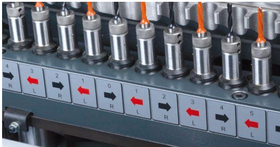
Figura 6: Diferenciación de husillos y brocas por color, para taladros múltiples.
