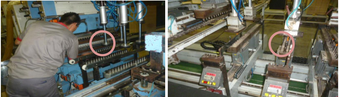
Figura 21: Posicionamiento de brocas en husillos.
