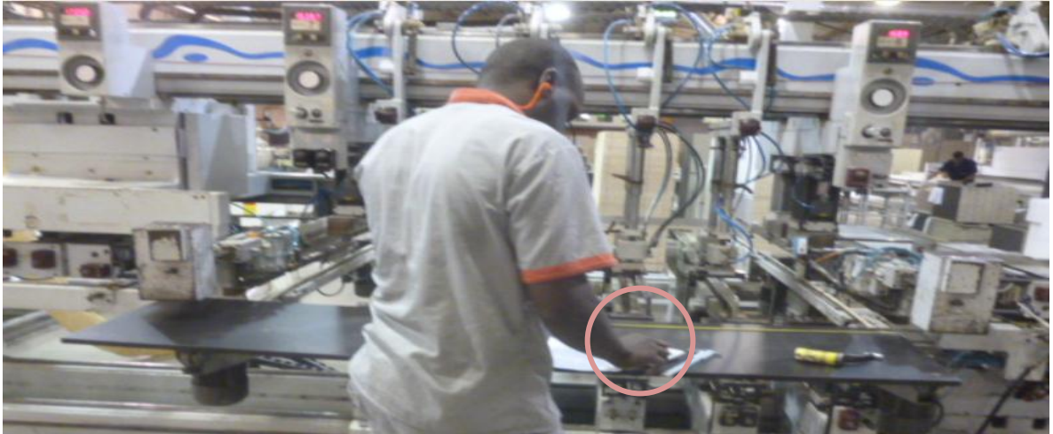
Figura 23: Verificación de distancia entre perforaciones sobre pieza de prueba.
