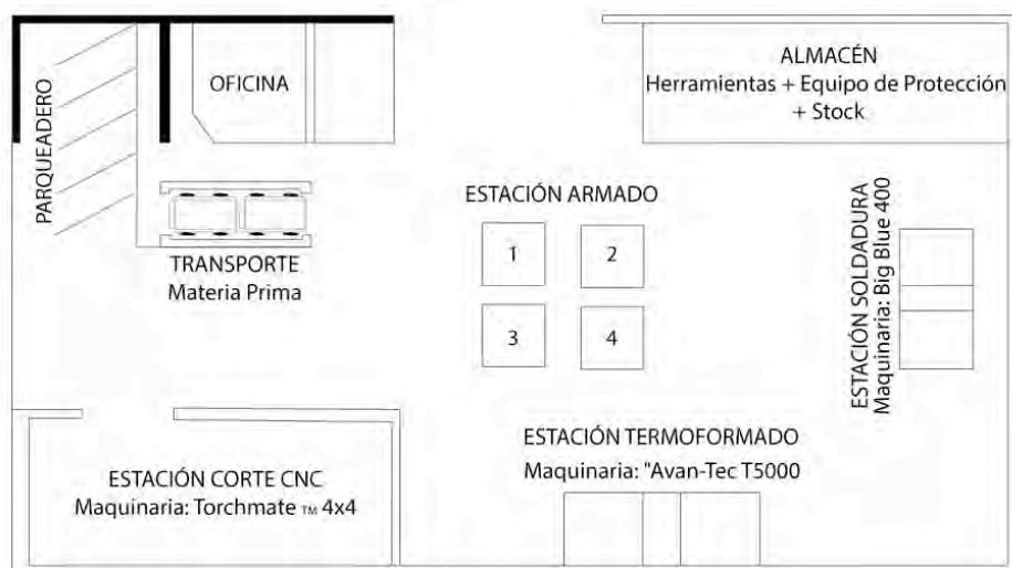
Ilustración 17. Distribución de planta
