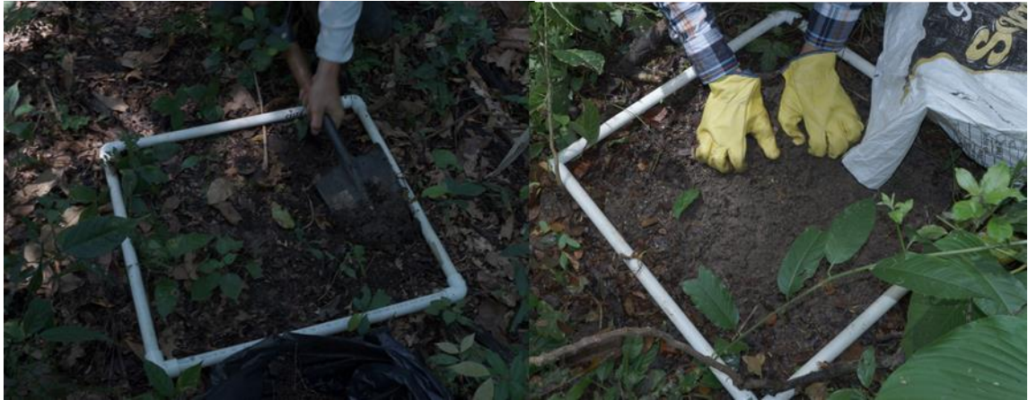
Figura 6. Marco de tubos de PVC de 50 x 50m para la extracción de la muestra de suelo.
