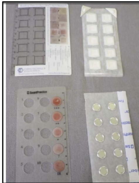
Imagen 1. Ejemplos de cámaras para los Patch Test (Lazzarini, Duarte, & Ferreira, 2013)
