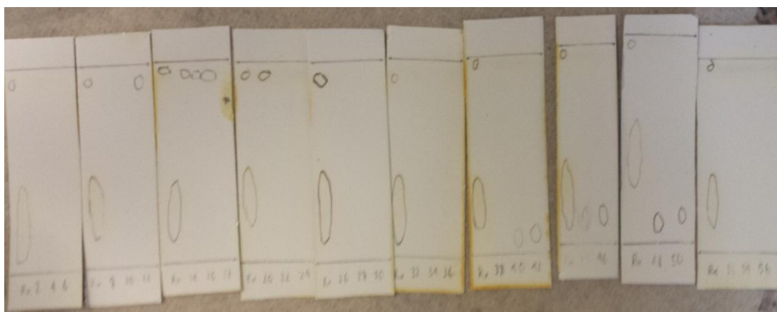
Figura 9. Placas de cromatografía de la purificación de P1.
