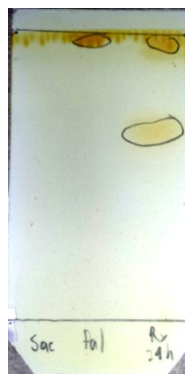
Figura 23. TLC obtenida con mezcla de cloroformo/metanol 9:1.
