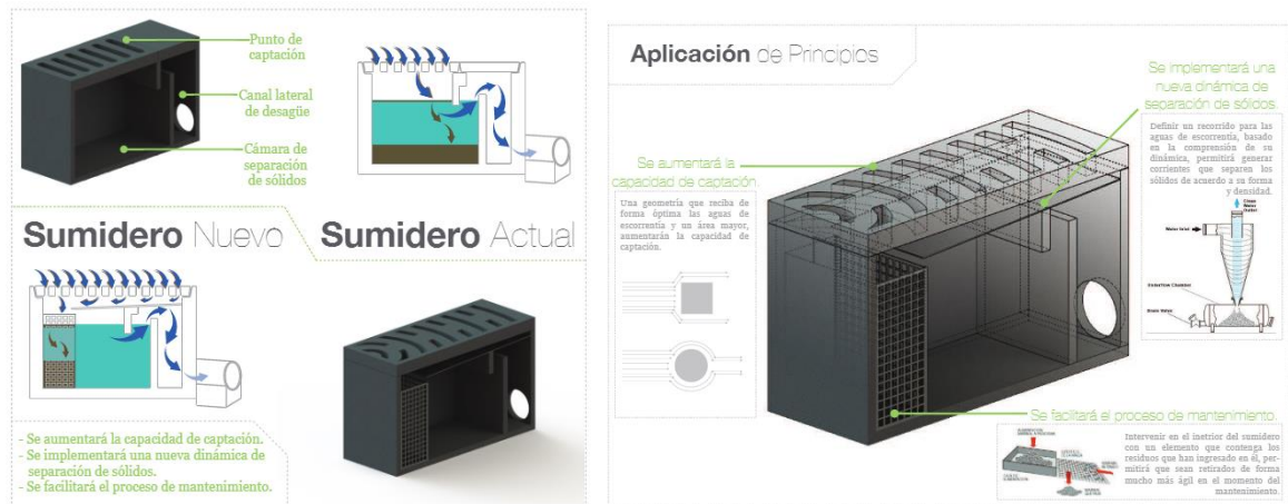
Ilustración 14 Primera propuesta: intervención geometría y estructura del sumidero
