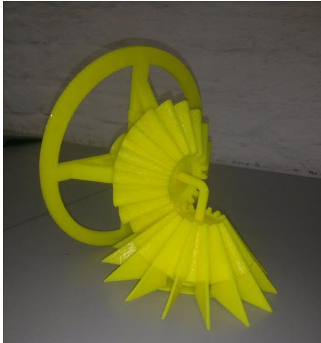
Ilustración 17 Alternativa piñón cónico impulsado por escorrentía
