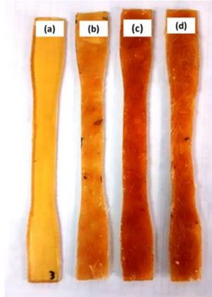
**Figura 18.** *Probetas tipo I del material polimérico con (a)0%v/v (b) 2,5%v/v (c) 5,0% v/v y (d) 7,5% de fibra de fique después de 72 horas de curado.*
