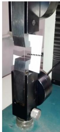
**Figura 7.** Sujeción de las fibras de Fique a la Máquina Universal de Ensayos.
