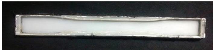
Figura 8. Molde en polipropileno para obtener probetas Tipo I
