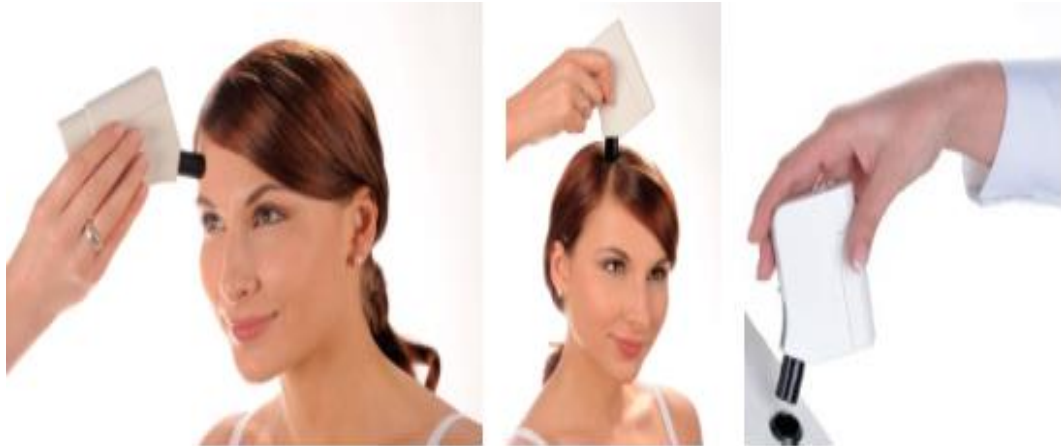
Figura 7. Medida del nivel de sebo por medio de el uso de la sonda Sebumeter ® (Courage-Khazaka eletronic GmbH)
