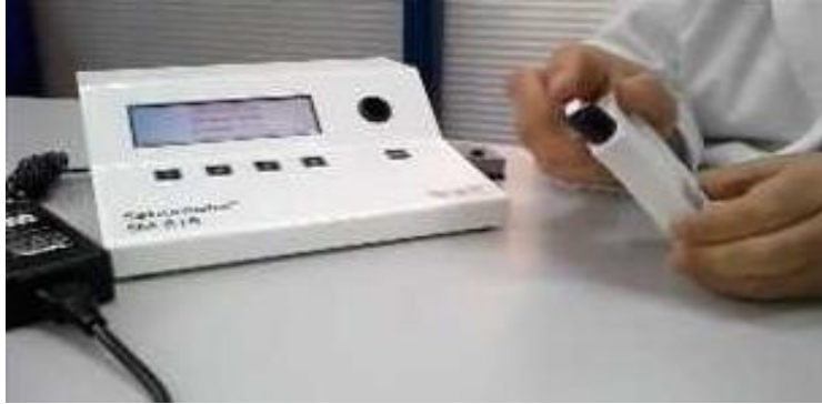
Figura 18. Cinta nueva de color blanco, previa a la introducción del cabezal del casete en la apertura del Multidermascop MDS 800 (Microcaya, S.L, 2013).
