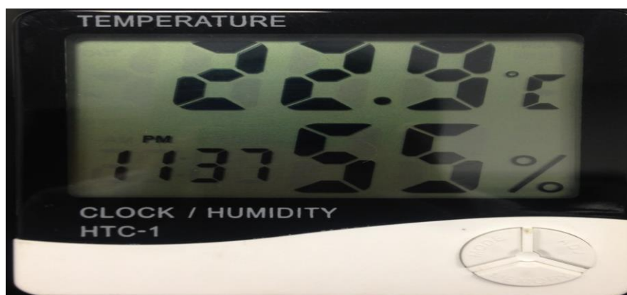
Figura 22. Termohigrómetro empleado para el control de temperatura y humedad dentro del laboratorio durante el estudio.
