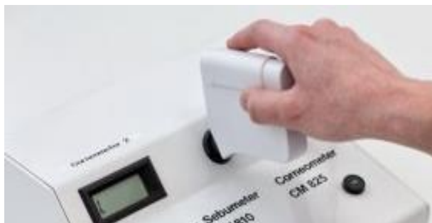
Figura 20. Medida de la cantidad de la luz transmitida tras los diez segundos de contacto con la piel grasa, equivalente al contenido de sebo en \mu\text{g} de sebo/ \text{cm}^2 (Microcaya, S.L, 2013).
