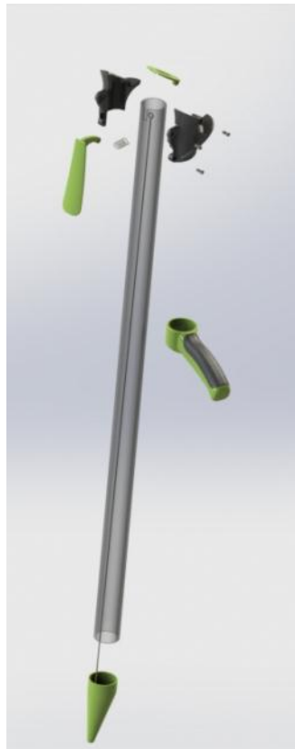
Fig. 37: Vista rápida del despiece del Dosificador.
