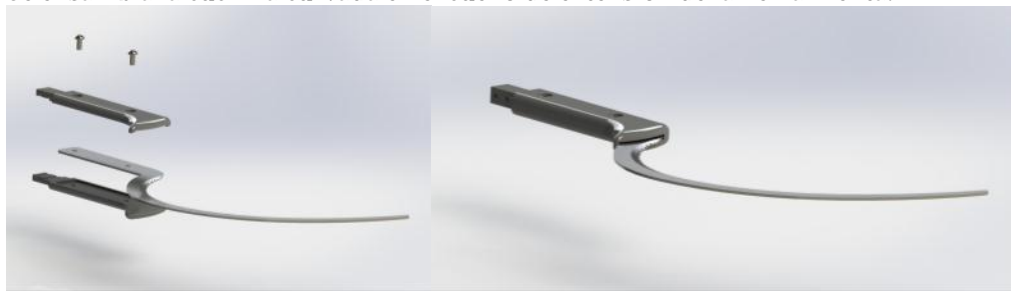
Fig. 45: Ensamble por tornillos de la cuchilla al cuello de extensión.
