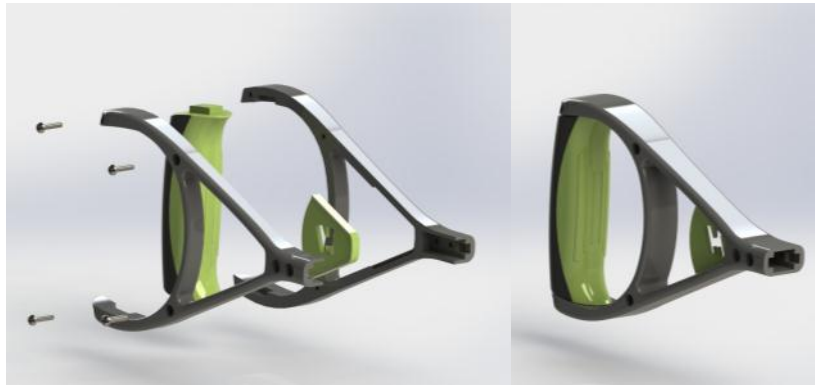
Fig. 44: Ensamble de carcasas estructura de mango de agarre.
