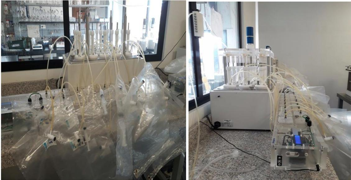
**Figura 2:** Montaje experimental para la obtención de biogás
