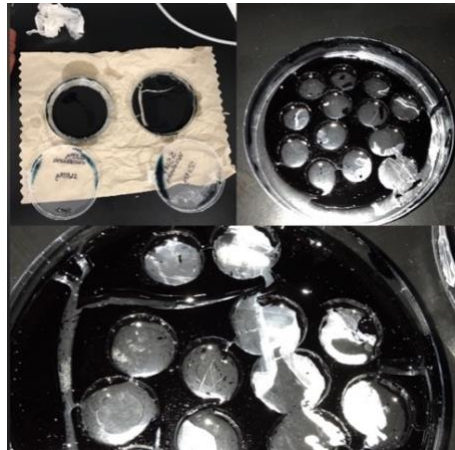
Figura 7. Síntesis de hidrogeles de quitosano/genipina con 0,3% de entrecruzamiento y dos concentraciones diferentes de fármaco venlafaxina HCl.
