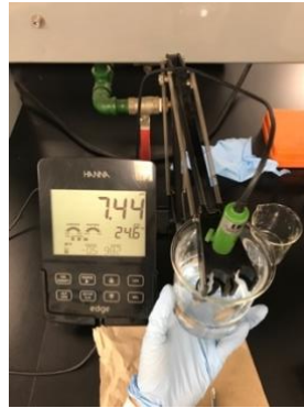
Figura 15. Ajuste pH 7,4 de solución buffer fosfato para cinética de liberación de venlafaxina a partir de los hidrogeles de quitosano/genipina al 0,3% de entrecruzamiento
