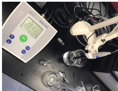
Figura 14. Ajuste pH 2 de solución buffer HCl para cinética de hinchamiento de los hidrogeles de quitosano/genpina al 0,3% de entrecruzamiento
