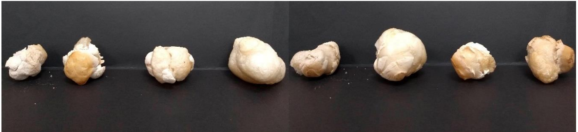
Figura 2 . Biscochos obtenidos de la prueba de capacidad de expansión hecha al almidón fermentado que se está estudiando. De izquierda a derecha se ubican en el siguiente orden: almidón sin fermentar, 3, 6, 12, 18, 24, 26 y 94 de fermentación. Fuente: Propiedad del autor.
