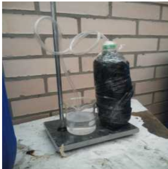
Ilustración 6: DISEÑO EXPERIMENTAL PROCESO DE FERMENTACIÓN JUGO DE CAÑA DE AZÚCAR
