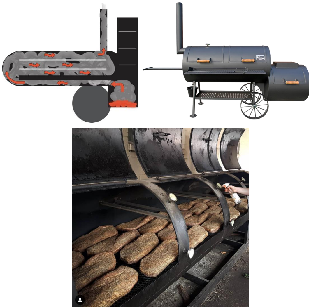
Figura 4. Diagrama técnico en ahumador offset. Fuente: https://www.instagram.com/adamsonbarbecue/
