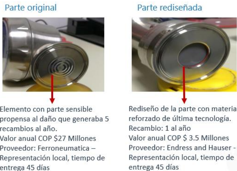
Figura 5: Prueba piloto, rediseño de parte con incremento en la vida útil y disminución del costo. Fuente: elaboración propia
