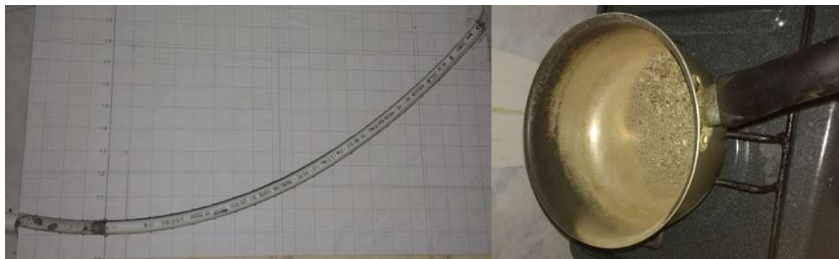
Figura 2.3-5 Fotografías del doblado de los tubos de PVC con arena caliente.
