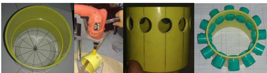
Figura 2.3-6 Fotos del proceso de construcción del centro del concentrador (vértice).
