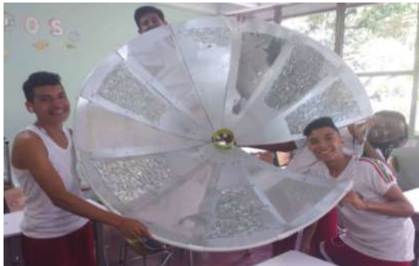
Figura 2.3-9 Foto de estudiantes terminando la estructura interna del paraboloide
