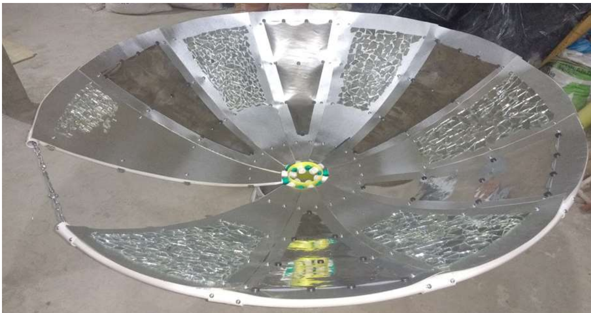
Figura 2.3-12 Fotos del concentrador solar terminado sin la base.
