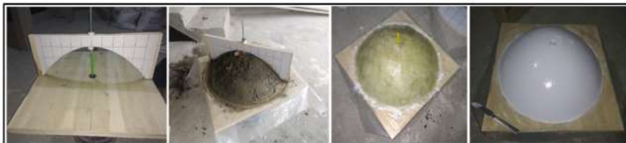
Figura 2.3-27 Foto de la construcción de paraboloides empleando fibra de vidrio, resina y gelcoat.
