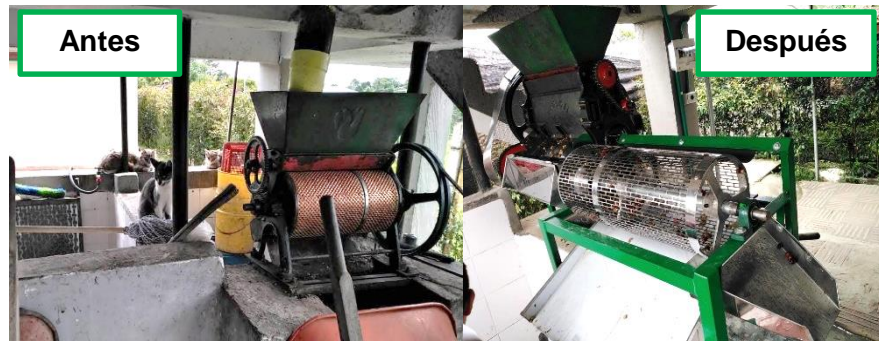
Figura 26: Fotos de la máquina despulpadora antes y después de la compra de la Zaranda Fuente: Autores
