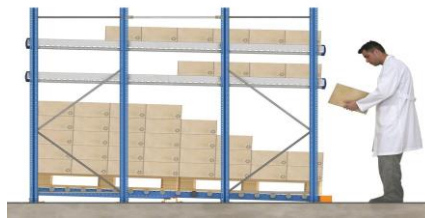
Ilustración 14. Estantería con sistema Carton Flow
