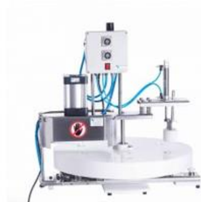
Gráfico 8 Maquiempanadas (máquina para empanadas y arepas CM07)
