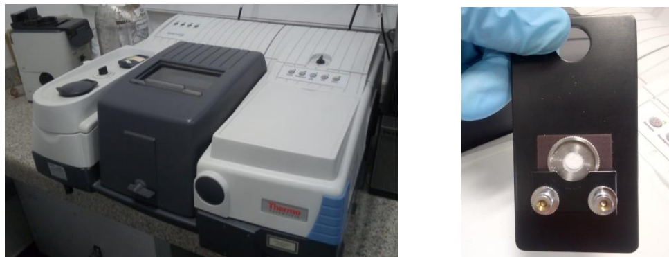
Figura 30. Equipo de Infrarrojo (FTIR) utilizado y muestra compactada en pastilla de KBr.
