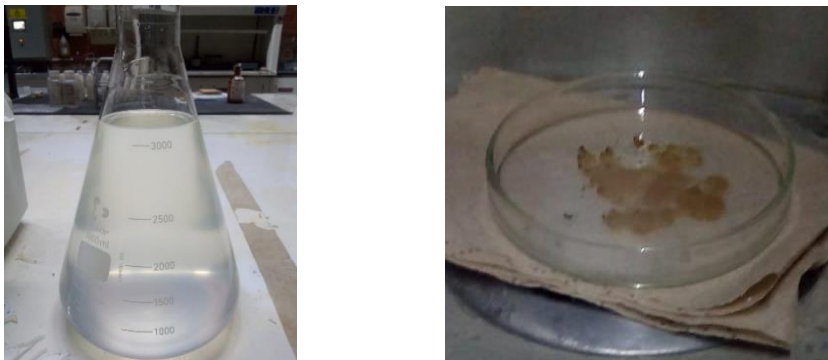
Figura 20. Segunda adición de soda al extracto y sólido precipitado después de centrifugación.
