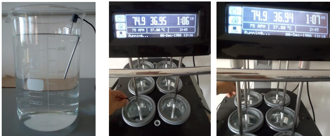
Figura 47. Verificación de la temperatura de la solución en cada uno de los vasos del disolutor.
