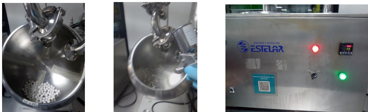
Figura 39. Aspersión de tratamiento de quitosano comercial de 2 % de concentración en HAC 1 % sobre núcleos de ibuprofeno y secado a 45°C.
