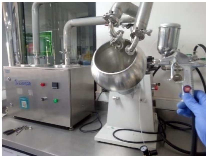
Figura 38. equipo de recubrimiento ensamblado.
