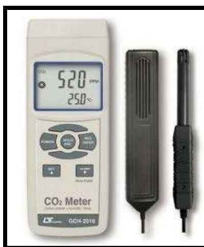
FIGURA 5. Equipo CO 2 Meter GCH-2018 junto con sus especificaciones
