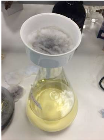
Figura 11. Montaje usado para la filtración del solvente usado en la extracción.
