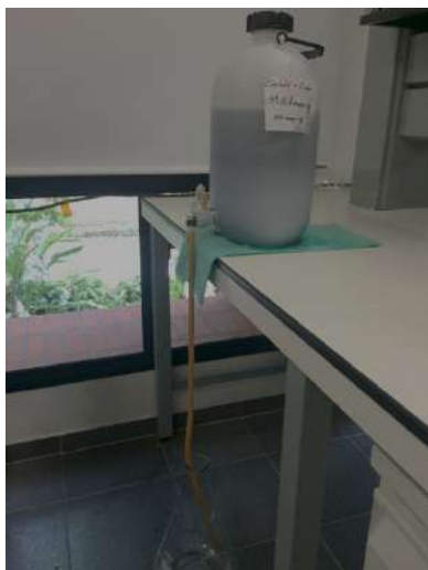
Figura 8. Montaje para realizar lavados a la muestra.
