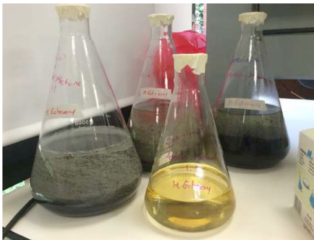
Figura 10. Muestra de carbón en extracción con solventes. Se observa un beacker mas pequeño (amarillo) con los solventes que ya extrajeron moléculas de interés.
