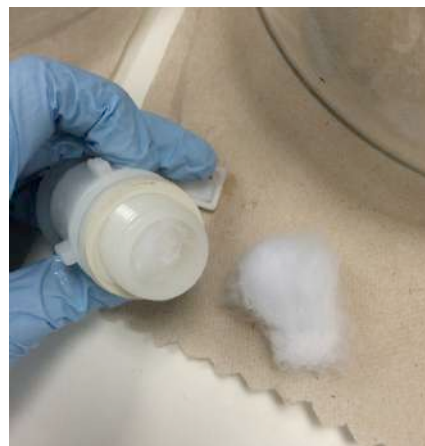
Figura 9. Algodón usado como filtro en la parte inferior del recipiente.
