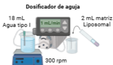
Ilustración 2. Montaje con dosificador de aguja y plancha de agitación.
