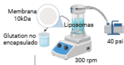
Ilustración 3. Montaje de Ultrafiltración
