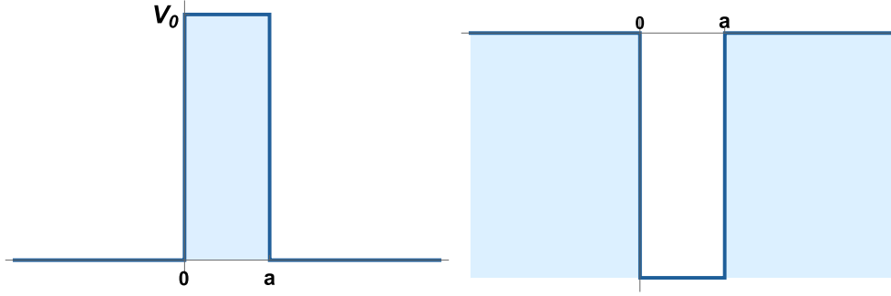
Ilustración 3: Función de potencial V(x) en los dos diferentes modelos de estudio. (izq) Potencial de barrera con V_0 > 0 . (der) pozo de potencial finito con V_0 < 0 . En ambos el ancho de la región \mathcal{R}_C es \Delta x = a .
