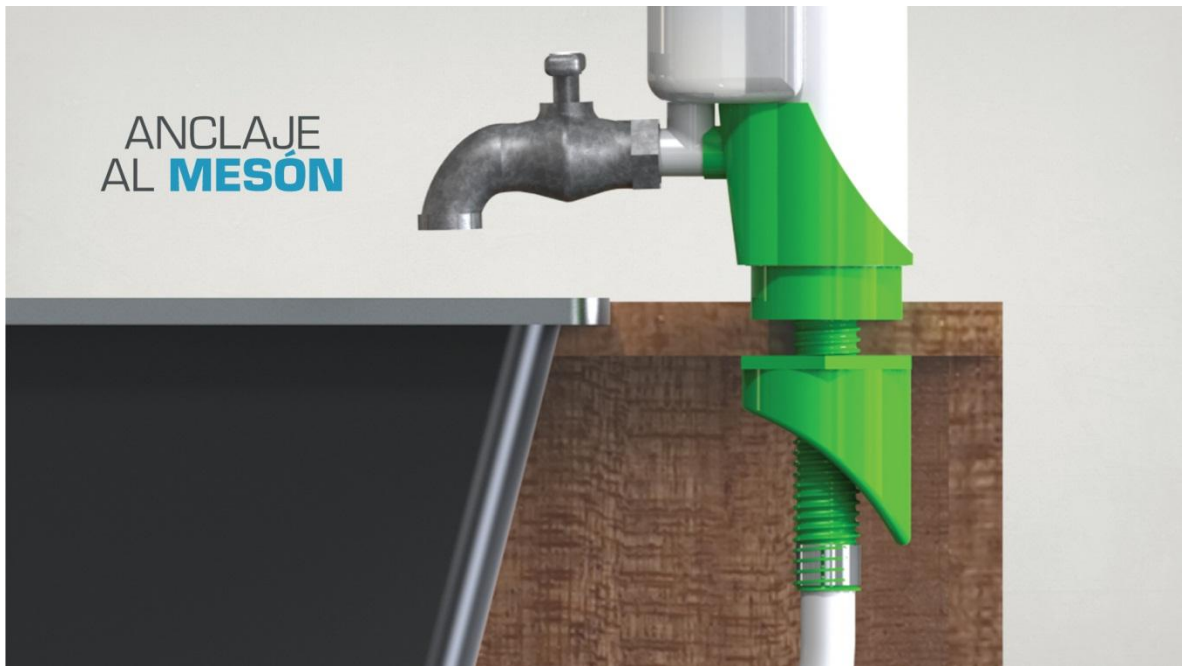
17 Anclaje de la unidad al mesón
