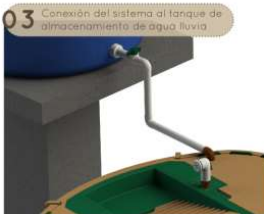
Imagen 48: Conexión al tanque de agua lluvia
