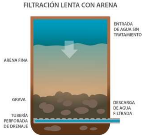
Imagen 37: Filtración lenta en Arena
