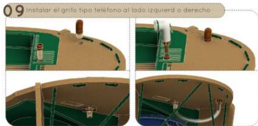
Imagen 63: Instalación del grifo tipo ducha teléfono
