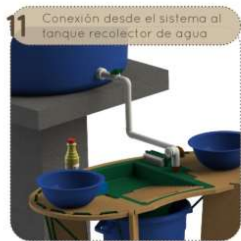
Imagen 65: Conexión al tanque de aguas lluvias
